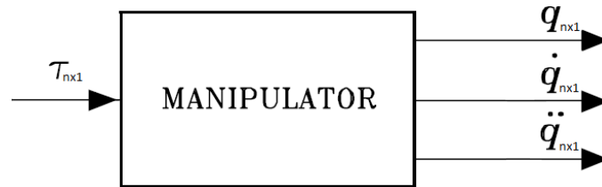
Εικόνα 3 Σχηματική αναπαράσταση πλήρους μοντέλου ρομποτικού βραχίονα
