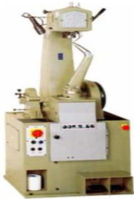
Σχ.4.2.4α Γαζωτική μηχανή ραψίματος με δύο πηνία νημάτων κατάλληλη για επιδιορθωτήρια και βιομηχανίες.
