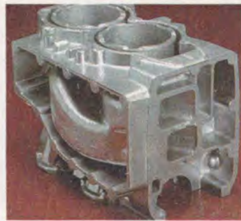
Σχήμα 10.11 : Χύτευση σε μόνιμο καλούπι
