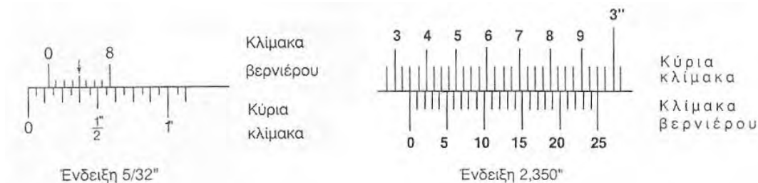
Σχήμα 2.6: Ανάγνωση ενδείξεων παχύμετρου (αγγλοσαξονικό σύστημα).
