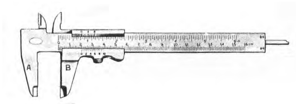
Σχήμα 2.3: Παχύμετρο με δυνατότητα μέτρησης και στα δύο συστήματα.
