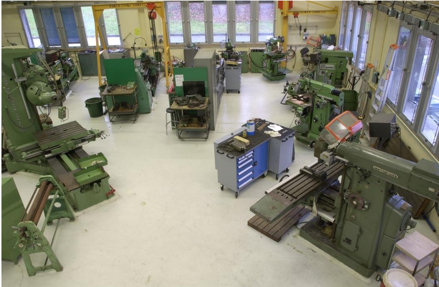
Μηχανουργείο – διάταξη συμβατικών εργαλειομηχανών
