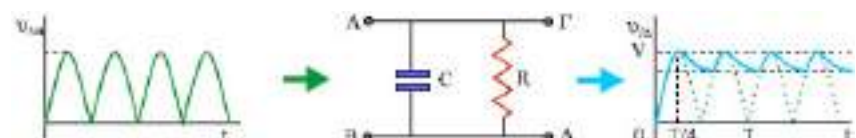
Σχ. 5.29 Με τον εξομαλυντή, η πλήρως ανορθωμένη τάση μετατρέπεται σε τάση σχεδόν σταθερή.
