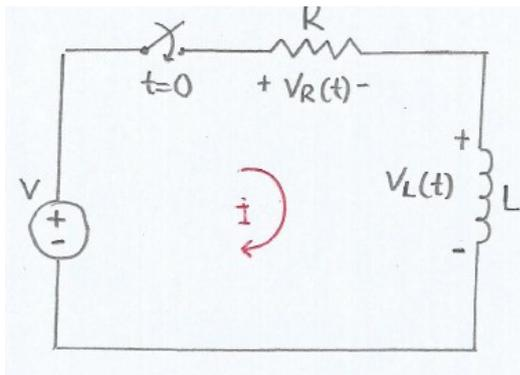
Το κύκλωμα του σχήματος δεν περιέχει πηγή, το δε πηνίο διαρρέεται αρχικά από ρεύμα  $I_0$  (αρχική συνθήκη  $i(0) = I_0$ ). Τη χρονική στιγμή  $t = 0$ , ο διακόπτης κλείνει οπότε, στο κύκλωμα, κυκλοφορεί ρεύμα  $i$ . Το ρεύμα αυτό είναι κοινό για τον αντιστάτη και το πηνίο, άρα  $v_L = L \frac{di}{dt}$ . Είναι προφανές ότι η μελέτη της απόκρισης του κυκλώματος αφορά το χρονικό διάστημα  $t \geq 0$ .
