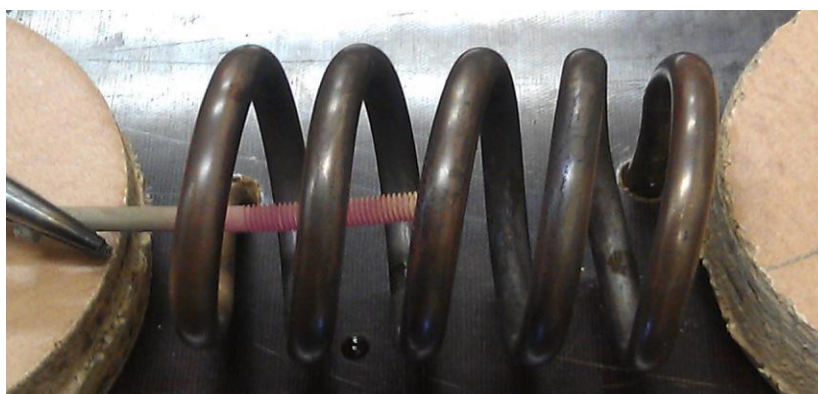
Σχήμα 9. Επαγωγή θερμότητας στο πηνίο
