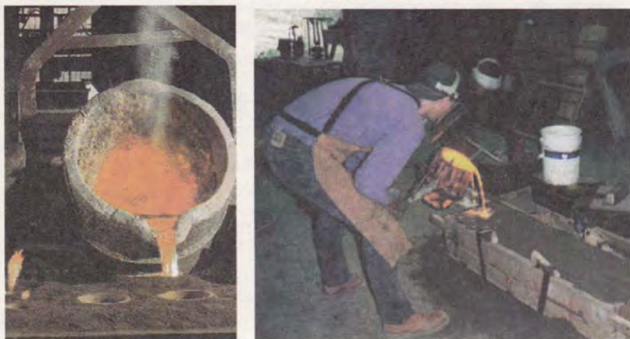
Σχήμα 10.4 : Χύτευση σε καλούπι από άμμο
