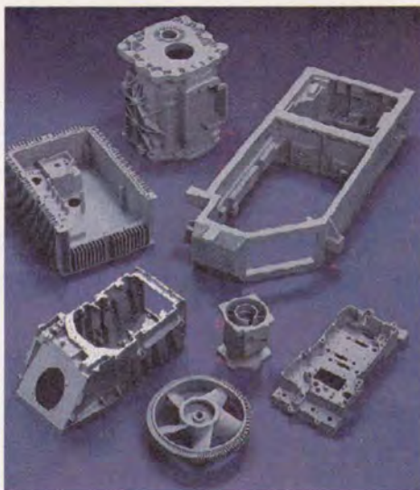
Σχήμα 10.8 : Παραδείγματα χυτών αντικειμένων από χύτευση σε γύψο
