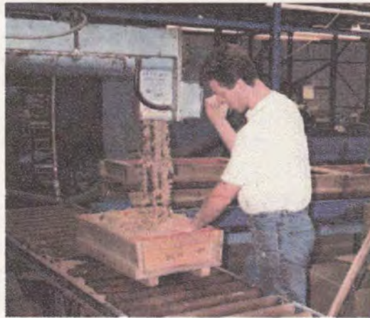
Σχήμα 10.6 : Μηχανική τροφοδοσία άμμου σε καλούπι
