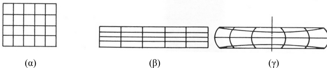
Σχήμα 5.2: Ομοιογενής και ανομοιογενής πλαστική παραμόρφωση: (α) σχηματική παράσταση του απαραμόρφωτου υλικού, (β) ομοιογενής πλαστική παραμόρφωση και (γ) ανομοιογενής πλαστική παραμόρφωση του υλικού.
