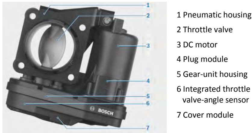
Σχήμα 4-2 Συσκευή ηλεκτρονικού ελέγχου της πεταλούδας στραγγαλισμού
