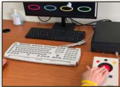
Εικόνα 138. Προσαρμοσμένο πληκτρολόγιο και trackball (Ε.Ε.Ε.ΕΚ. Αγ. Δημητρίου)
