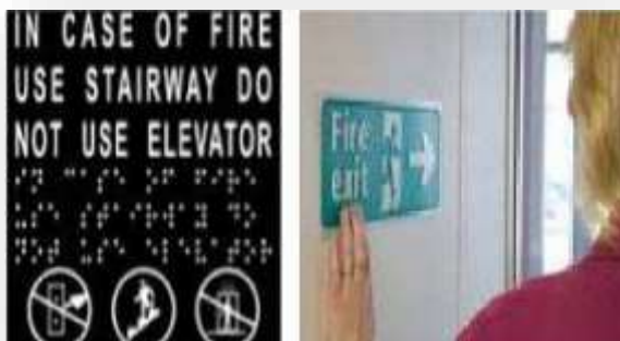
Εικόνα 63. Σήματα διαφυγής σε ανάγλυφη γραφή τυφλών (Braille) (Δημουλά, κ.ά., 2023)
