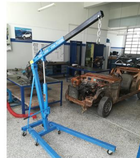
Εικόνα 4: Η Αλυσίδα του μηχανήματος ανύψωσης/μετακίνησης των εργαστηρίων οχημάτων των ΕΠΑ.Λ.
