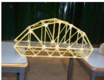
Σχ. 1 Παράδειγμα γέφυρας «σπαγγέτι» τύπου δικτυώματος.
